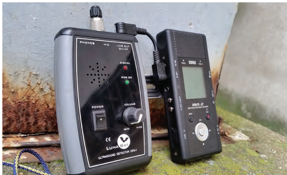
Fot. 24. Detektor ultradźwiękowy pracujący w systemach frequency division oraz full spectrum, połączony z rejestratorem nagrywającym do plików WAV z próbkowaniem 192 kHz (DZ)
